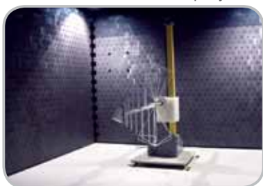
Камера, экранированная от электромагнитных помех
