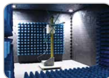
Камера, экранированная от электромагнитных/радиочастотных помех
